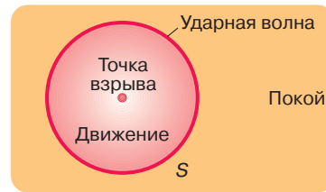
Рис. 2. Распространение сферической ударной волны от точечного взрыва
