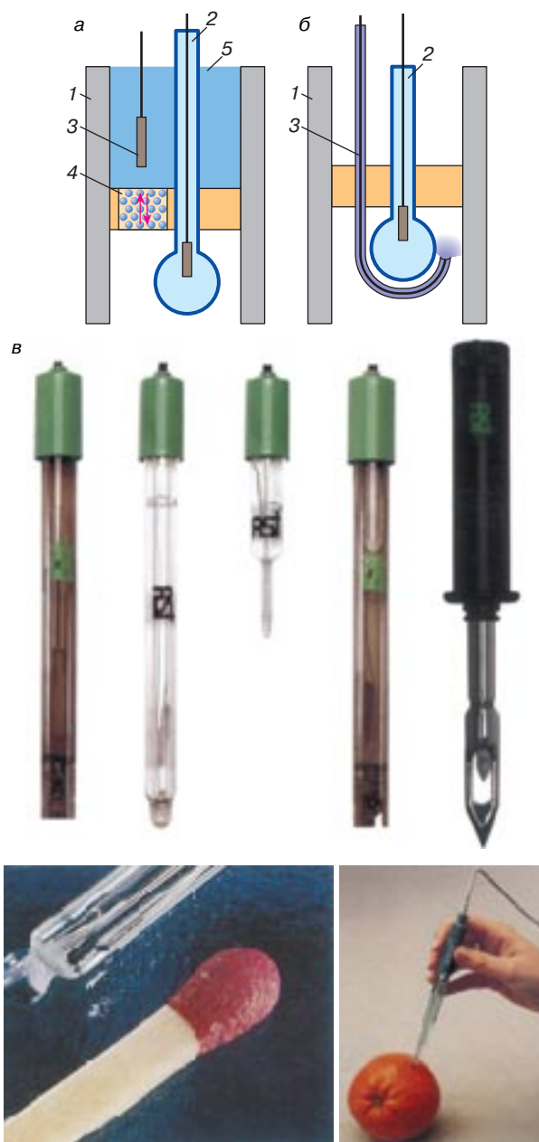
Рис. 2. Устройство комбинированных стеклянных электродов фирмы "Hach" и их конструкция: а – электрод с пористой мембраной: 1 – корпус, 2 – стеклянный электрод, 3 – электрод сравнения, 4 – пористая мембрана, 5 – раствор KCl ; б – электрод с минимизацией диффузионного потенциала (стабилизация крайне малого диффузионного потенциала поддерживается за счет постоянно обновляемого солевого раствора в приэлектродной области, так называемое стационарное состояние); 1 – корпус, 2 – стеклянный электрод, 3 – электрод сравнения с протекающим через него раствором KCl ; в – примеры конструкций комбинированных электродов различного аналитического назначения других фирм
