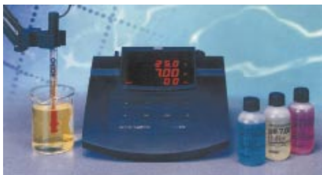
Рис. 1. Современная установка для прецизионного определения pH. Слева направо: комбинированный электрод; pH-метр (на шкале показания: температура раствора, величина pH, потенциал индикаторного электрода в мВ); сосуды со стандартными буферными растворами
