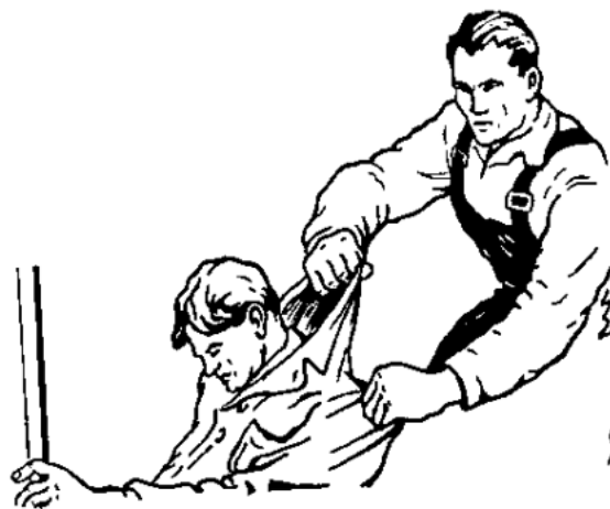
Рис.6. Освобождение пострадавшего от тока для ЭУ напряжением до 1000 В отгаскиванием за сухую одежду
