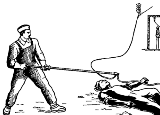
Рис.8. Освобождение пострадавшего от тока для ЭУ напряжением до 1000 В отбрасыванием провода сухой деревянной доской
