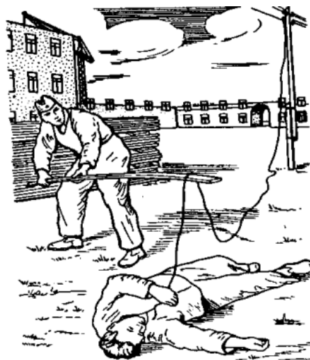
Рис.8. Освобождение пострадавшего от тока для ЭУ напряжением до 1000 В отбрасыванием провода сухой деревянной доской
