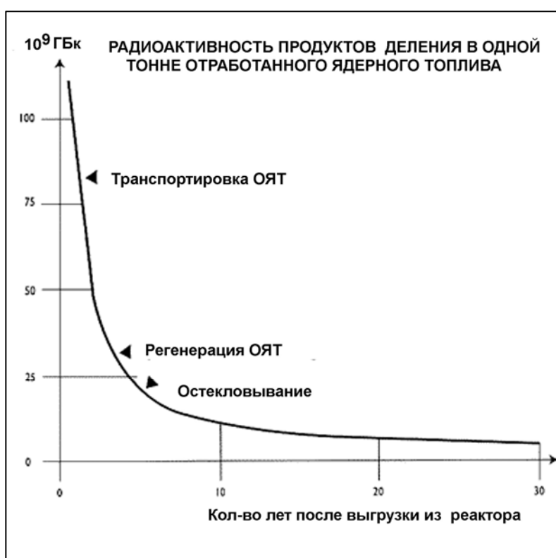
Рисунок 6. Уменьшение уровня радиоактивности продуктов деления в одной тонне отработанного ядерного топлива PWR реактора
